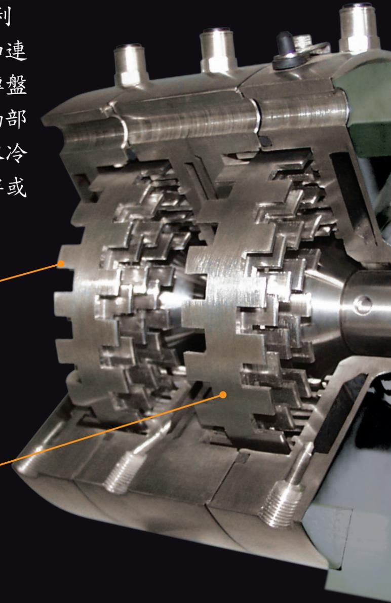
CR攪拌器可應用在各類型的液體加工產品上，以及需要起泡工藝的產品，而在流程中的添加物外加部件可多至4個，可安裝在攪拌的前、後段各2個，使攪拌或起泡的產品在加工過程中有更多的選擇和靈活發揮。
